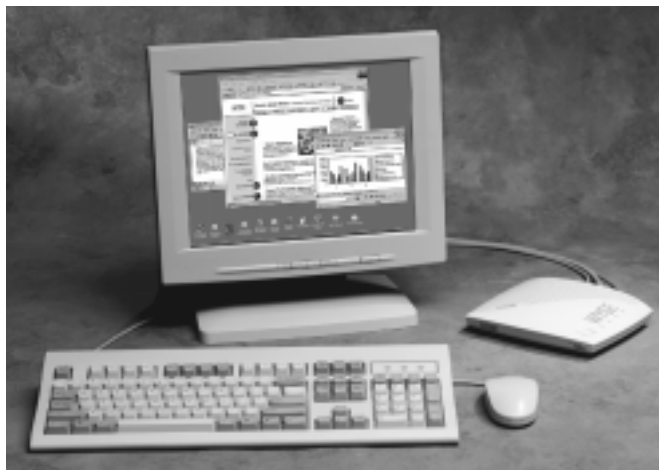
Abbildung 10.1: Windows CE-Terminal WT32000 LE von Wyse
