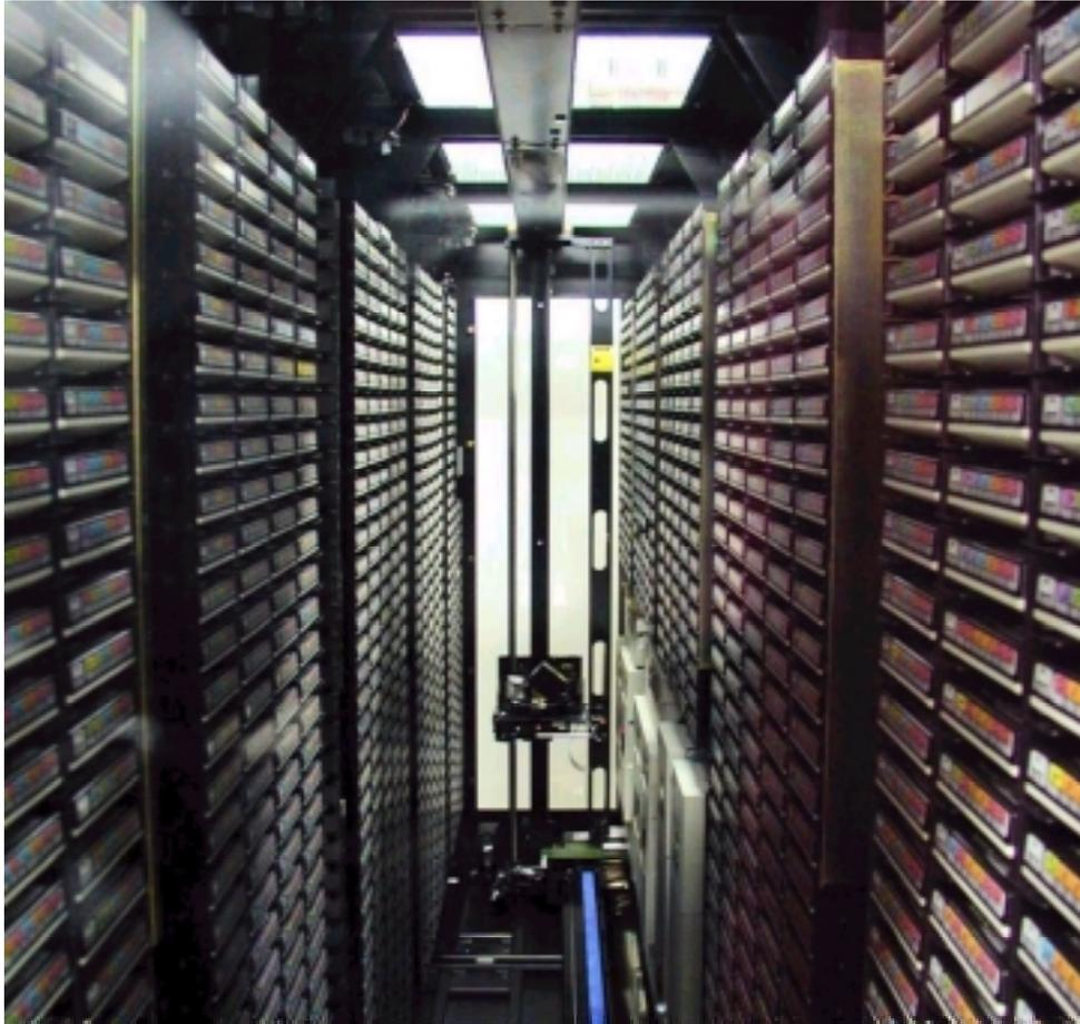
**Abbildung 5-5: Magnetband Backup-System (Quelle: [www.kes.info/](http://www.kes.info/))**
